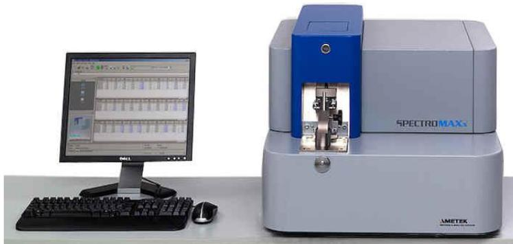
FIGURE 6.17 – Spectromètre à excitation par étincelage utilisé au département de métallurgie.
