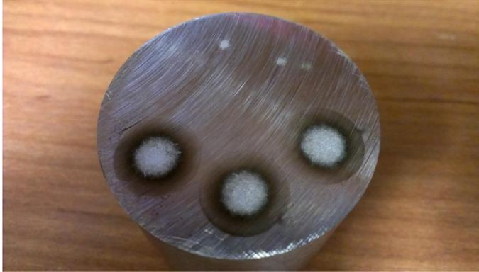
FIGURE 6.18 – Échantillon après l'analyse par étincelage.
