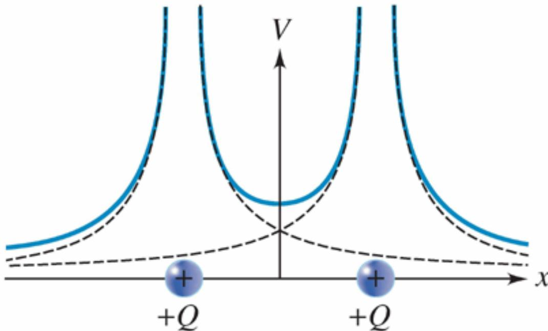
**Figure 5.4 Potentiel électrique d'un système composé de deux charges ponctuelles positives en fonction de la position  $x$ .**
