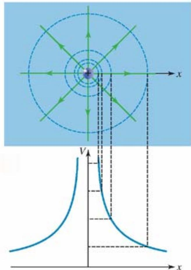
**Figure 5.3 Potentiel électrique d'une charge ponctuelle : schéma (équipotentielles et champ électrique) et fonction potentiel  $V_E = kQ/x$ .**
