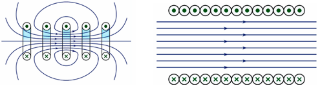
Figure 7.9 Champ magnétique d'un solénoïde : cinq spires séparées d'une certaine distance et coupe transversale de plusieurs spires collées les unes sur les autres.
